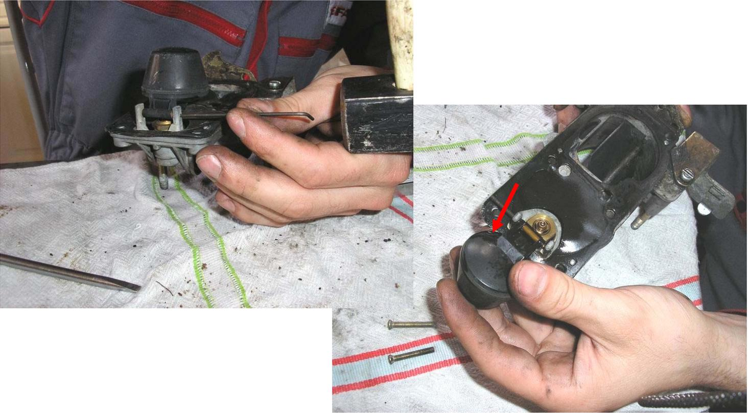
Puis on enlève le flotteur. Pour pouvoir l'enlever, il faut pousser la tige qui le maintient. L'idéal est de prendre une pointe fine (une aiguille par exemple) et d'extraire l'axe en faisant comme sur la photo.
