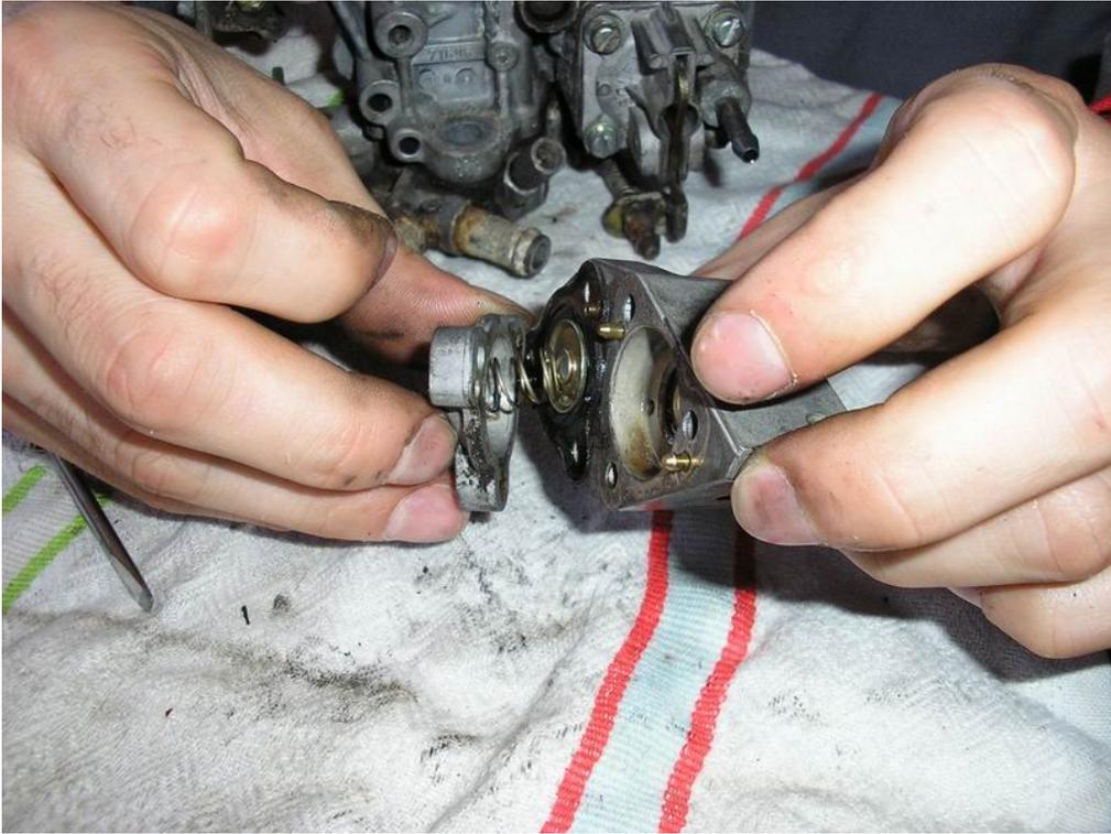
Démonter la membrane d'enrichissement pleine charge (attention au ressort !).
