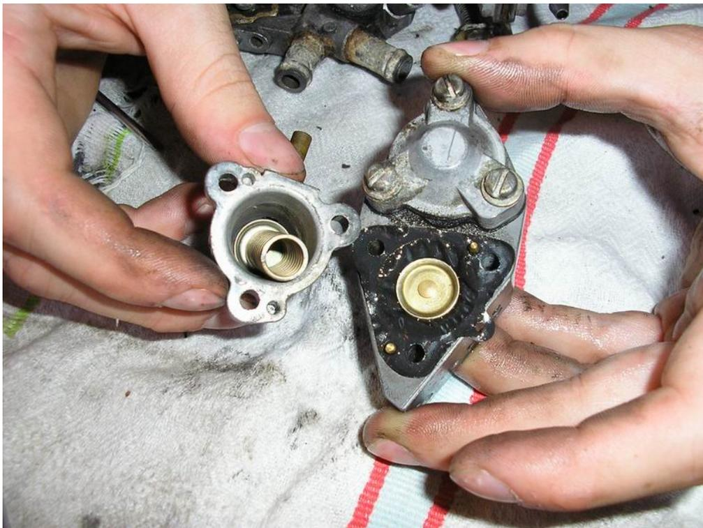
Démontage de la partie régulation d'essence en suralimentation. Prendre garde de ne pas abîmer la membrane (dans mon kit de joint, il n'y avait pas de membrane neuve !).
