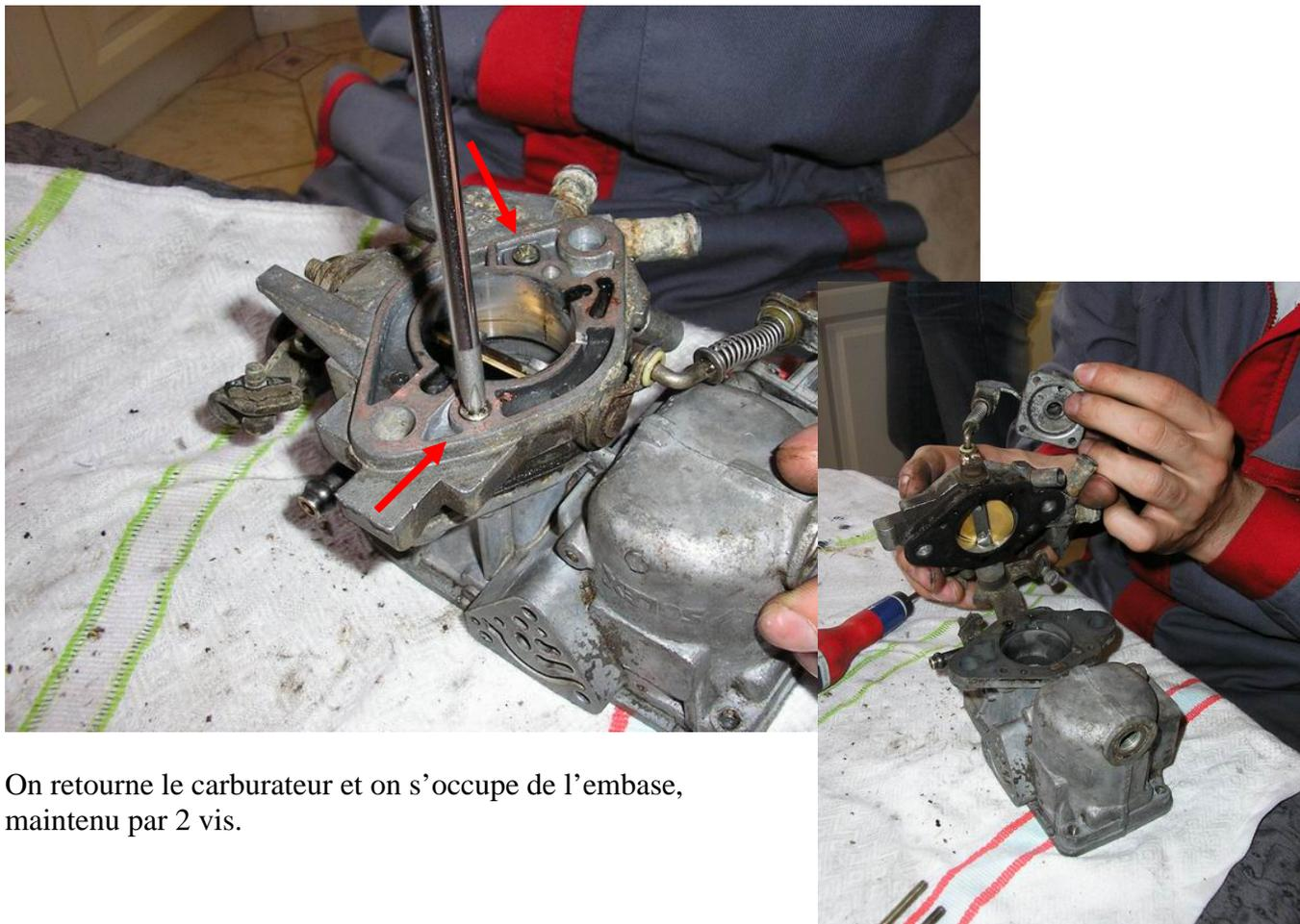
On retourne le carburateur et on s'occupe de l'embase, maintenu par 2 vis.
