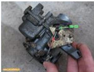
Et voilà, le carburateur est prêt à être remonté sur la pipe d'admission en n'oubliant pas évidemment la cale pare-chaleur et les 2 joints de part et d'autre de cette cale.
