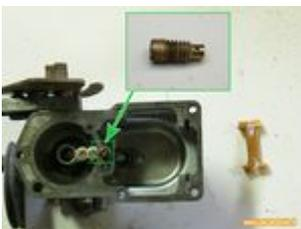
Démonter le gicleur principal pour le nettoyer => un simple tournevis suffit pour le retirer. Le but étant de vérifier que rien ne bouche les orifices du gicleur, un coup de soufflette ne faisant jamais de mal.
