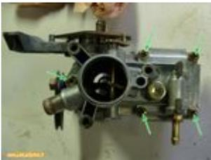
Ouvrir la cuve du carburateur en dévissant les 5 vis situées sur le dessus du carbu ce qui permet de procéder à quelques vérifications à l'intérieur.
