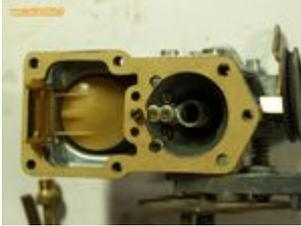
Remonter la cuve en mettant un joint neuf. Il s'agit juste d'un joint en "carton" qui ne demande pas de précaution particulière au moment de la pose.
