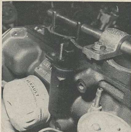
Montage du pignon de commande d'allumeur (boulon Ø 12 mm au pas de 175)
