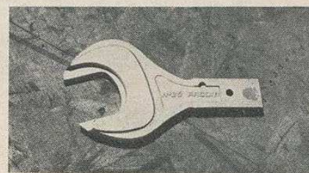
Clé pour dépose boîtier écrou différentiel. Réf. B.Vi 494
