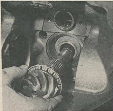
Dégagement de la pignonerie de l'arbre secondaire
