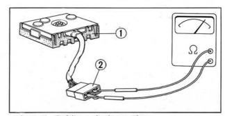
Fig. 5-17 ① Silicon diode rectifier ② Coupler
