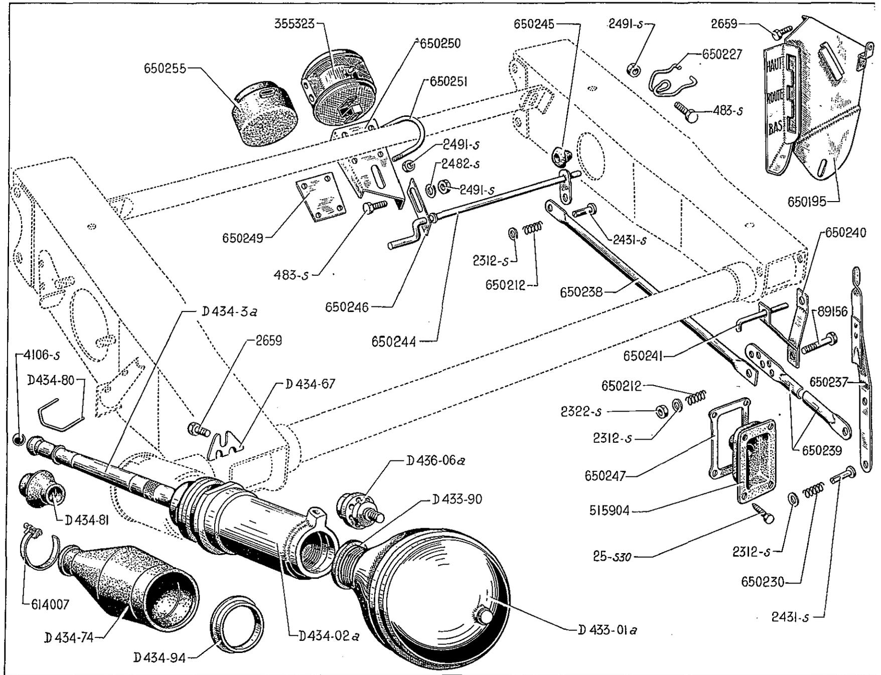
250 — COMMANDE DE CHANGEMENT DE ROUE - CORRECTEUR - CYLINDRE DE SUSPENSION
