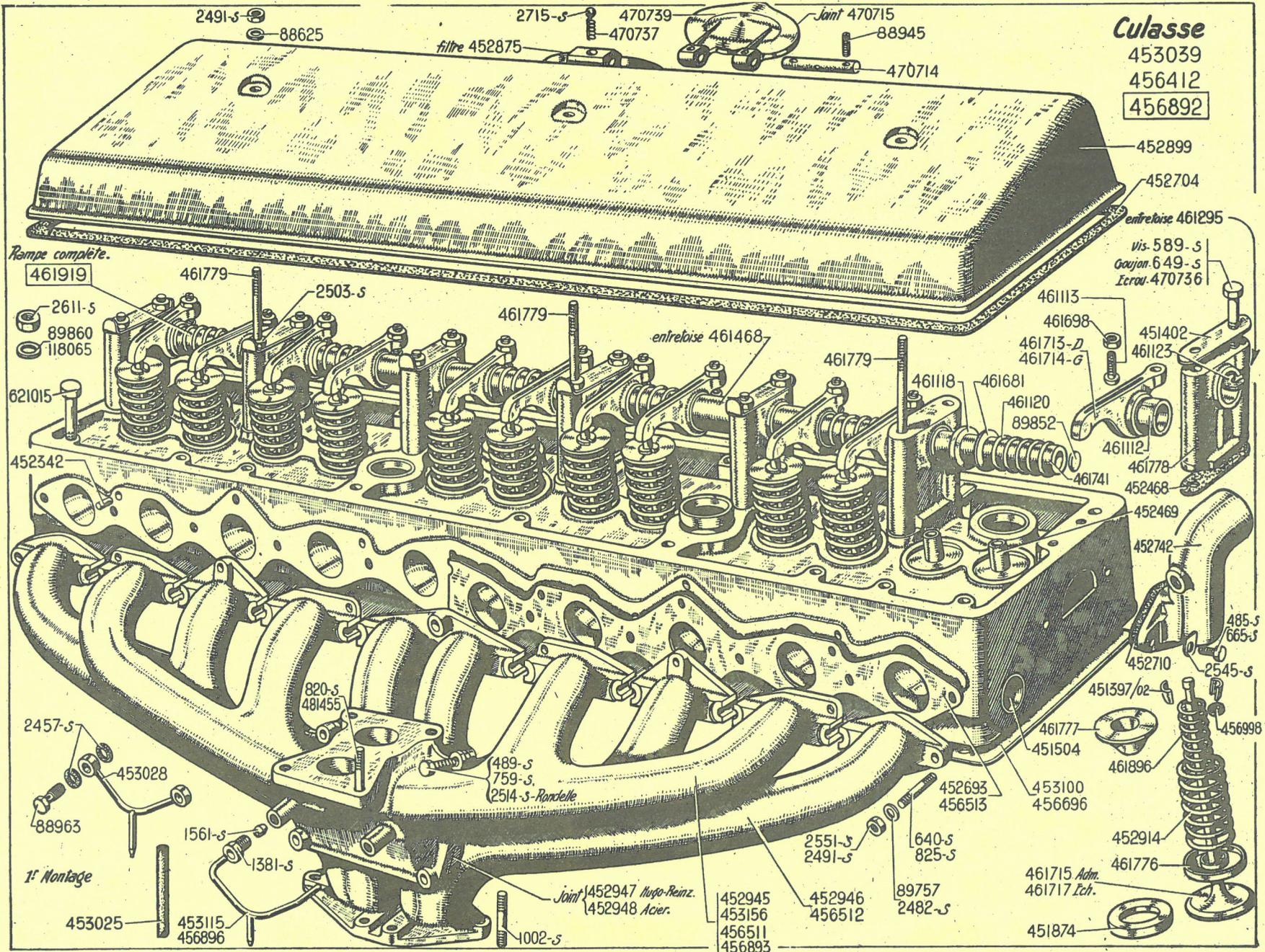
112 — CULASSE - TUBULURES - RAMPES DE CULBUTEURS
