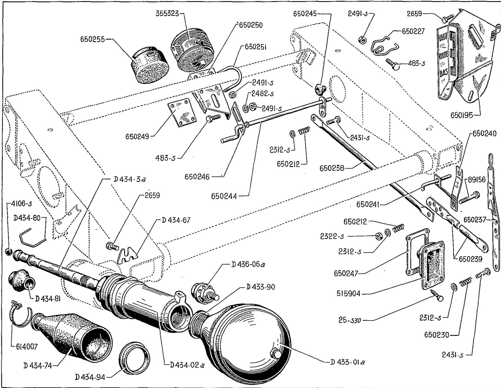
**- COMMANDE de CHANGEMENT de ROUE - CORRECTEUR CYLINDRE de SUSPENSION - 6H (Suite) -**
