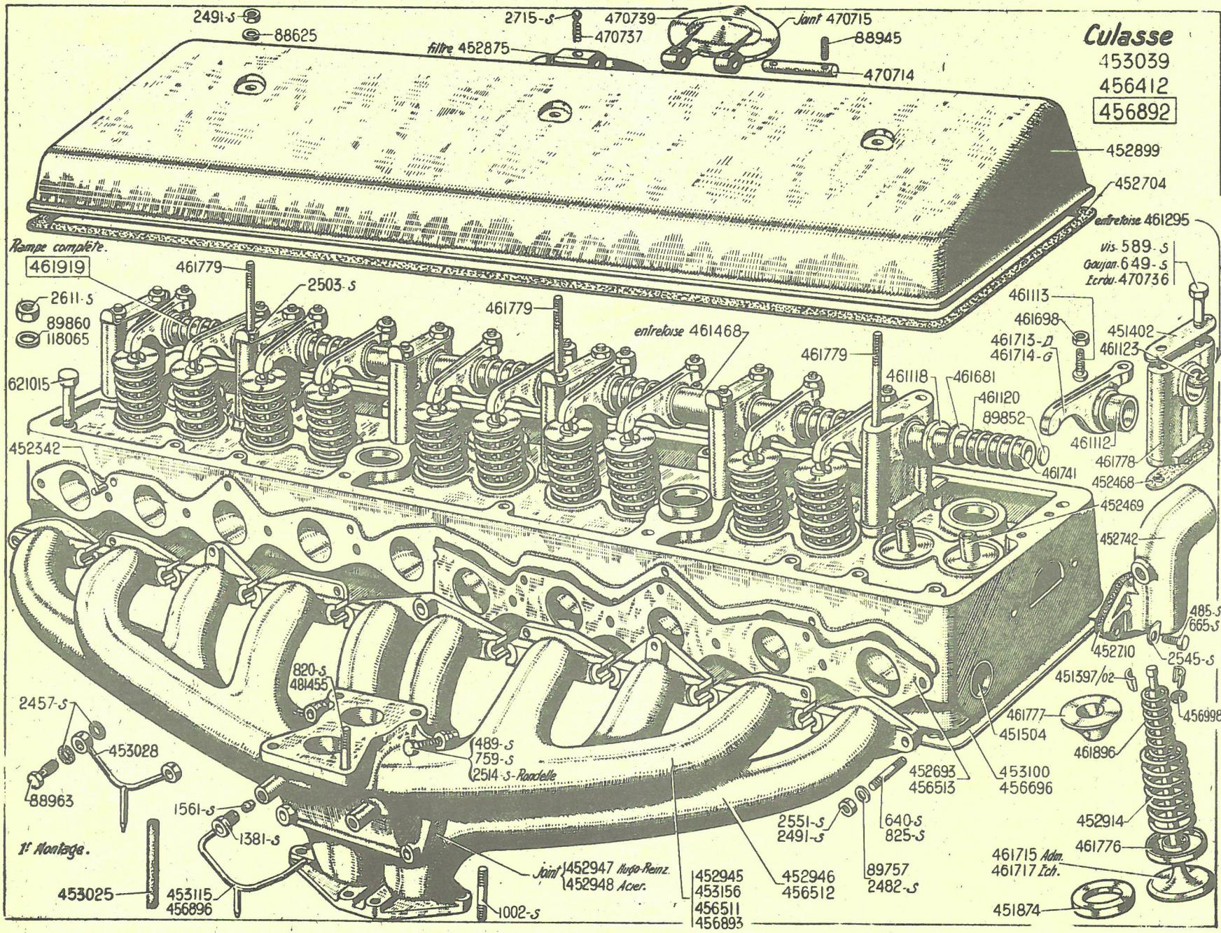
**CULASSE - TUBULURES - RAMPES DE CULBUTEURS — 109**
