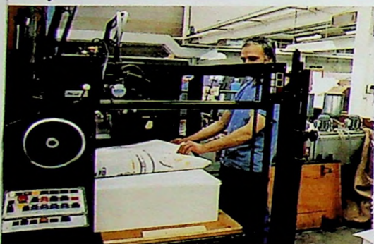
Le papier est mis en place pour l'impression du 2 e côté des feuilles. (Photo Desmoulins)
