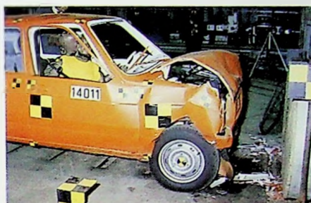
Pas de pitié pour les nouveaux véhicules : ils subissent tous des essais multiples qui ont pour but de vérifier s'ils sont conformes aux normes officielles (ici, essai de recul du volant et choc au mur).
