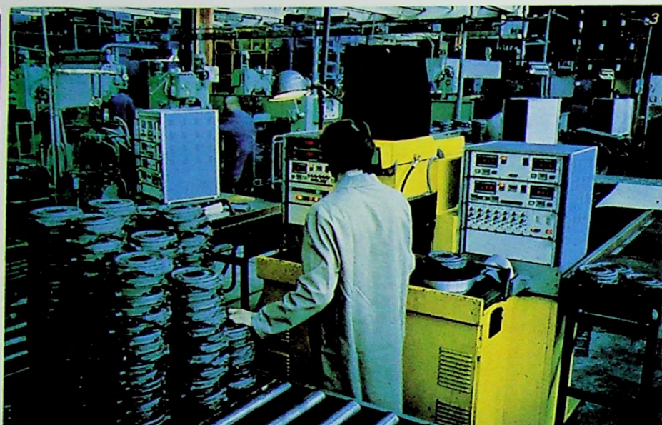
Machine pour le contrôle final des mécanismes à diaphragme chez le fournisseur.
