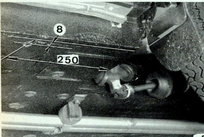
3°) Percer un trou de  $\varnothing = 10$  mm sous chaque plancher arrière (fig. 3).
