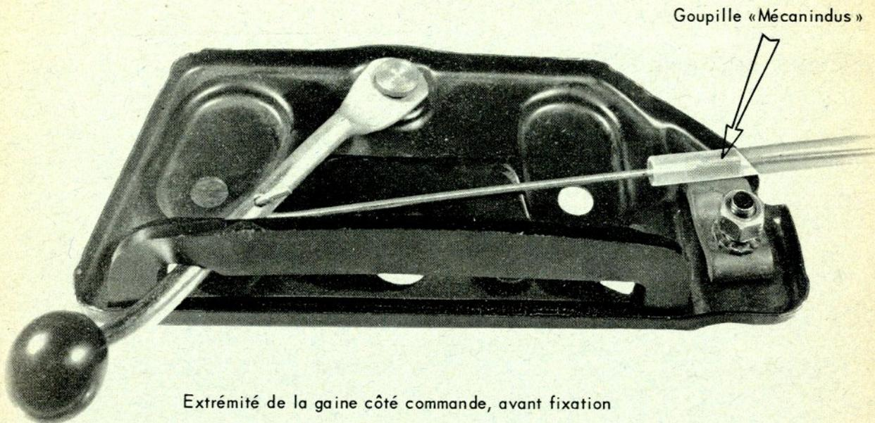
Extrémité de la gaine côté commande, avant fixation
