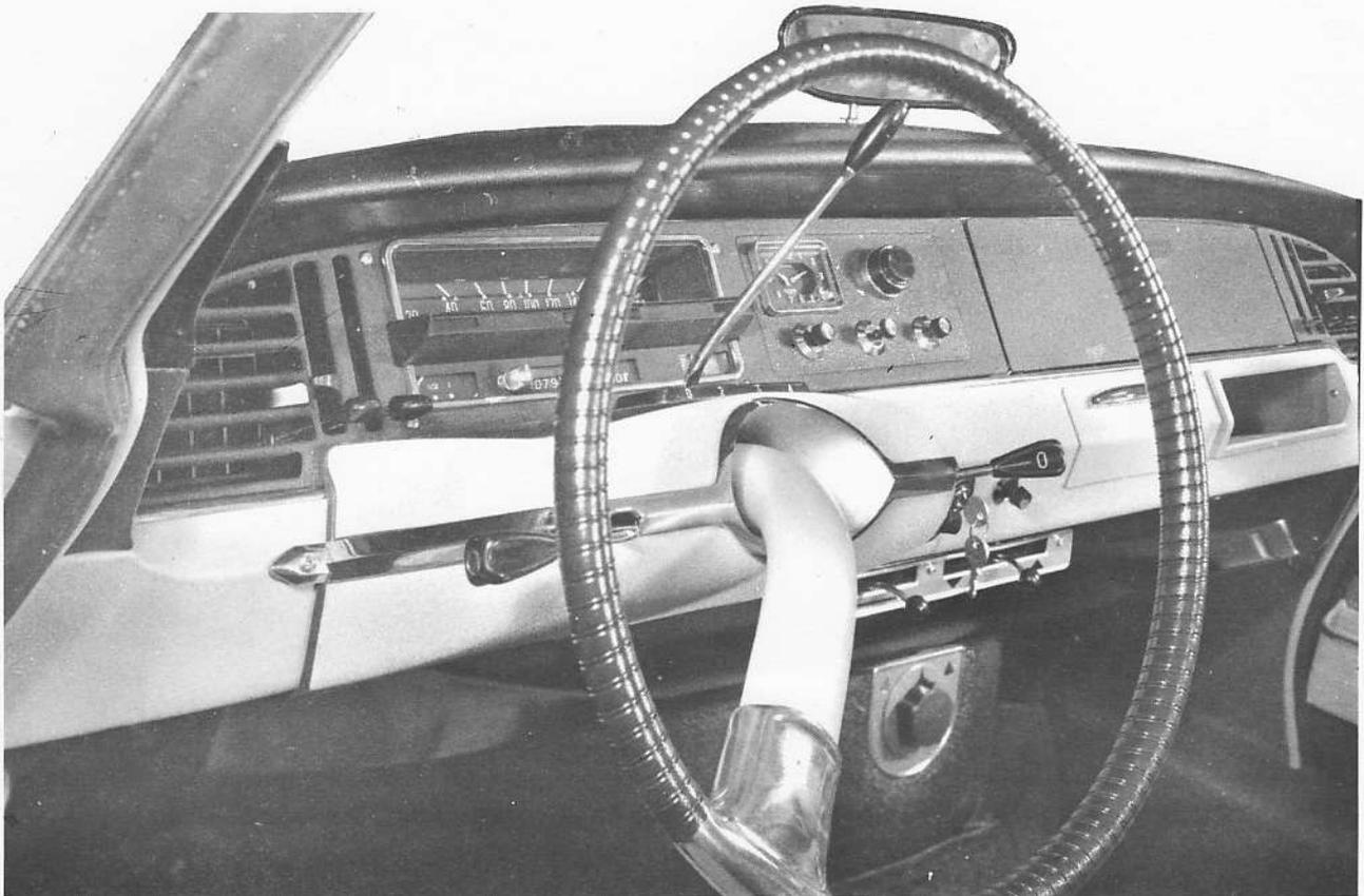
La planche de bord est inchangée. Le support de commandes électriques et son couvercle sont ceux montés en DX ou DY.
