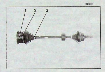
4. Déposer le joint tripode :
