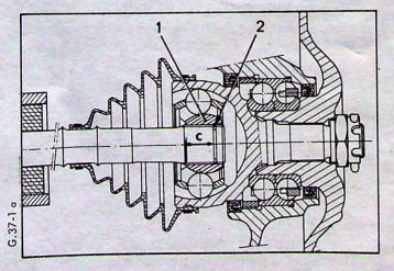
REMARQUE : Ne sont vendus que les nouveaux joints à billes dont le diamètre de fusée est augmenté et possède 25 dentelures. En cas d'échange d'un joint à billes premier modèle (22 dentelures) par un joint à billes deuxième modèle (25 dentelures), il est nécessaire de remplacer l'ancien moyeu de roue par le nouveau.
