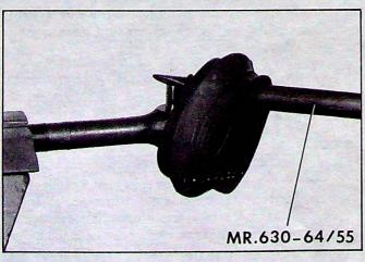
d) Enduire de graisse (TOTAL MULTIS.MS) les rotules et les aiguilles. Les mettre en place sur le tri-axe.
