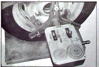
Pour les véhicules sortis depuis le 8 Septembre 1972. le pincement des roues vers l'avant doit être de 0 à 2 mm.
