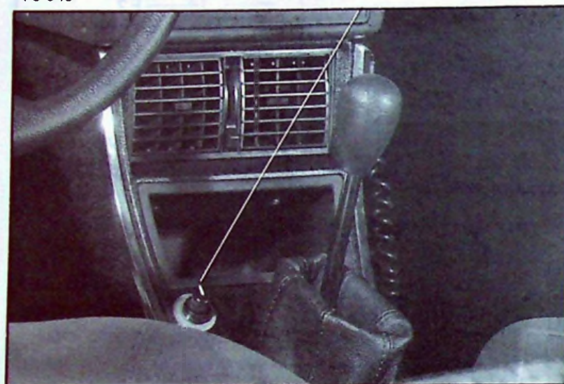
Interrupteur de climatisation
