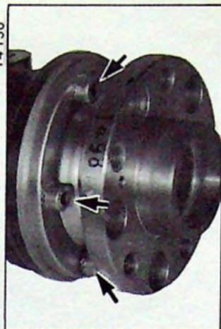
16. Mettre en place le moyeu sur le bras :
