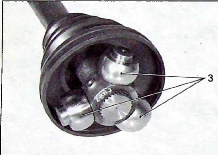
6. Enduire de graisse (TOTAL MULTIS MS) les rotules (3) et les mettre en place sur le tri-axe.
