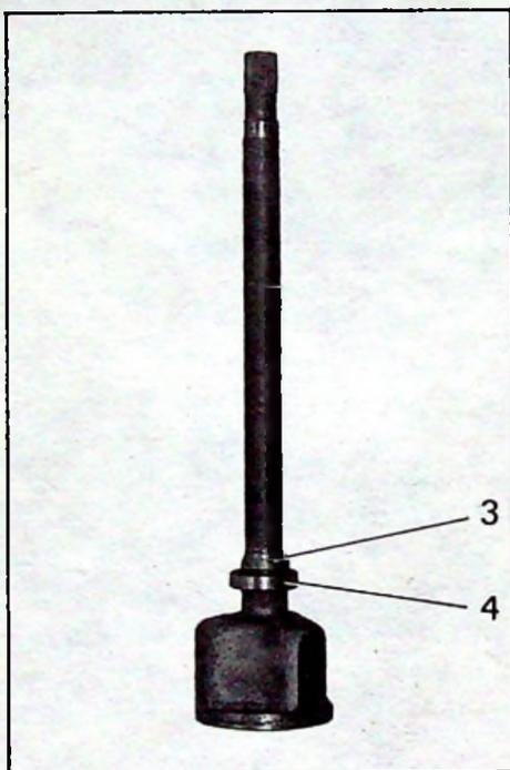
2. Déposer la bague d'arrêt (3) et le roulement (4) :
