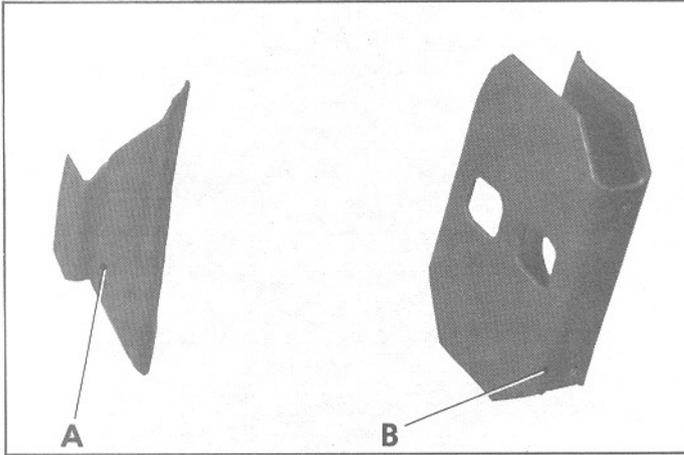
NOTA : Le Service des Pièces de Rechange fournit les pieds milieux sans gâche soudée. Il est donc nécessaire, suivant la date de sortie des véhicules, de procéder à la pose, soit de la gâche A (Véhicules sortis avant Septembre 1972), soit du support de gâche B (Véhicules sortis depuis Septembre 1972).
