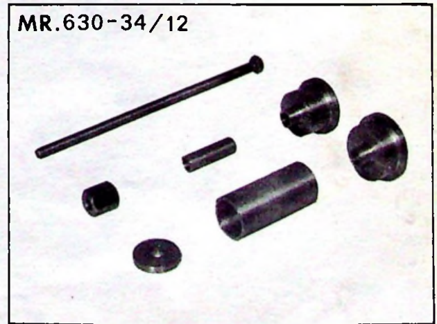
Outillage pour remplacement des guides de soupapes
