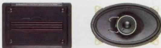
■ 95 x 153mm-2-Weg-Lautsprechersystem ■ TS-4624 mit Abdeckung ■ TS-4623 ohne Abdeckung ■ Empfindlichkeit: 90dB/W/m ■ Frequenzbereich: 50 ~ 20.000Hz ■ Einbautiefe: 43mm
