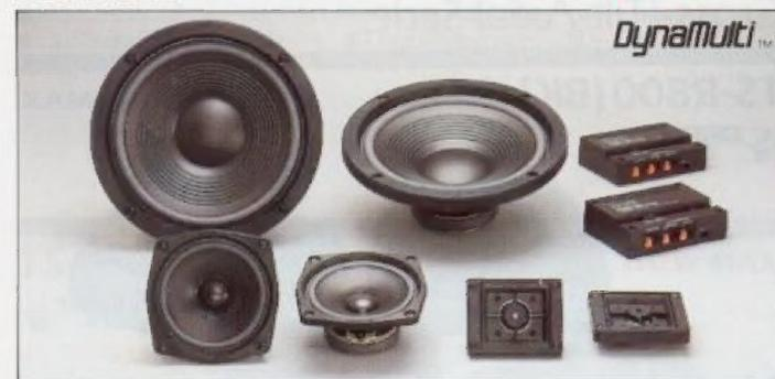
■ 3-Weg-Lautsprechersystem für erweiterten Frequenzgang und geringe Verzerrung ■ Ausgewogener HiFi-Sound über das gesamte Hörspektrum ■ Pegelwähler für Mittel- und Hochtöner ■ Maßgeschneiderter, unsichtbarer Einbau ■ Abmessungen (B x H x T): 274 x 118 mm (Durchmesser x T, Tieftöner), 135 x 135 x 62 mm (Mitteltöner), 99 x 78 x 30 mm (Hochtöner), 145 x 103 x 41 mm (Frequenzweiche)
