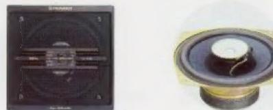
■ 130mm-2-Weg-Lautsprechersystem ■ Empfindlichkeit: 90dB/W/m ■ Frequenzbereich: 45 ~ 20.000Hz ■ Einbautiefe: 54mm
