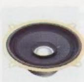
■ 130mm-Doppelkonus-Lautsprechersystem ■ Empfindlichkeit: 91dB/W/m ■ Frequenzbereich: 60 ~ 18.000Hz ■ Einbautiefe: 47mm
