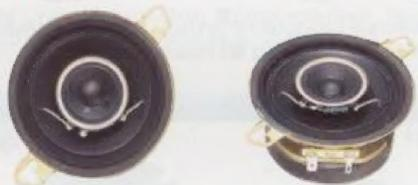
■ 87mm-2-Weg-Lautsprechersystem ■ Empfindlichkeit: 90dB/W/m ■ Frequenzbereich: 90 ~ 20.000Hz ■ Einbautiefe: 40mm
