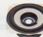
■ 100mm-Doppelkonus-Lautsprechersystem ■ Empfindlichkeit: 90dB/W/m ■ Frequenzbereich: 50 ~ 17.000Hz ■ Einbautiefe: 36mm
