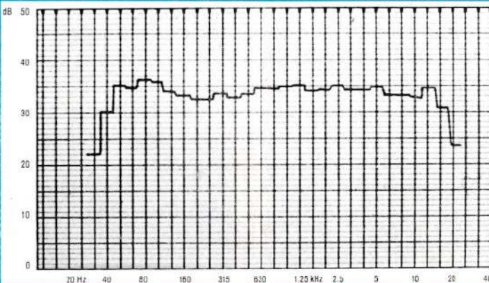
Pression acoustique en fonction de la fréquence dans un salon "standard"
