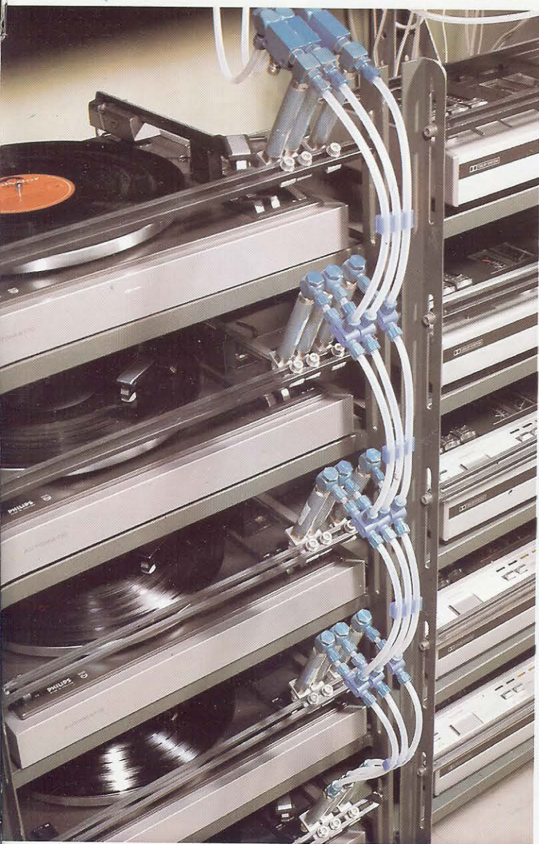
1. Beproeving van de levensduur, 220 uur lang: 3 uur aan, 1 uur uit.
