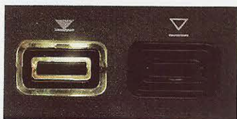
Verlichte tiptoetsen voor de handbediening.
