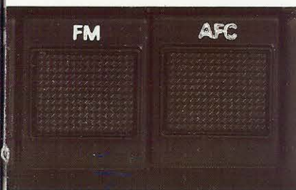
Uitschakelbare AFC voor optimale en eenvoudige afstemming van FM-zenders.
