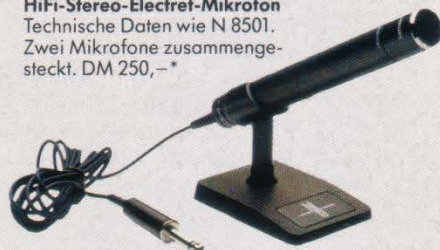
N 8215 (N 8216) HiFi-Electret-Mikrofon Kugelcharakteristik. Empfindlichkeit: 0,25 mV/μbar. Frequenzbereich: 50–18 000 Hz (DIN 45 500). Impedanz: 800 Ohm. Ausführung: N 8215 mit Klinkenstecker 6,3 mm; N 8216 mit 2 Klinkensteckern, 3,5 mm für die NF, 2,5 mm für Start/Stop DM 30,—*
