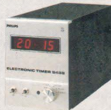
LFD 2432 Elektronisch einstellbare Digital-Schaltuhr zum präzisen Einschalten der angeschlossenen Geräte (z. B. Cassetten-Recorder, Spulentonbandgerät, Tuner, Amplifier). Mit dem Zentralschalter auf der Frontplatte des Timers lassen sich alle 4 Steckdosen gemeinsam ein- und ausschalten, wobei die vorgeählte Zeit-Schaltfunktion Vorrang behält. Abmessungen der Front: B x H: 102 x 143 mm. Kombination Timer + Cassetten-Deck N 2542: 482 x 143 mm. Front: Metall, silberfarben. DM 179,—*
