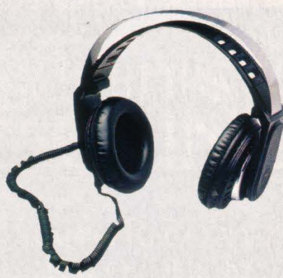
N 6330 HiFi-Stereo-Kopfhörer Eine aktive Membrane und sechs passive Membranen bilden eine extrem große Abstrahlfläche und bieten damit einen hervorragenden Klangeindruck, besonders bei tiefen Frequenzen. Ausführung: Klinkenstecker 6,3 mm. Frequenzbereich: 16–20 000 Hz (DIN 45 500). Impedanz: 2 x 600 Ohm. Gewicht: 400 g. DM 198,—*
