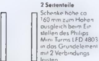
**2 Seitenteile** Schenke höhe ca 160 mm zum Hohen ausgleich beim Einstellen des Philips Mini Turms LFD 4803 in das Grundelement mit 2 Verbindungsleisten
