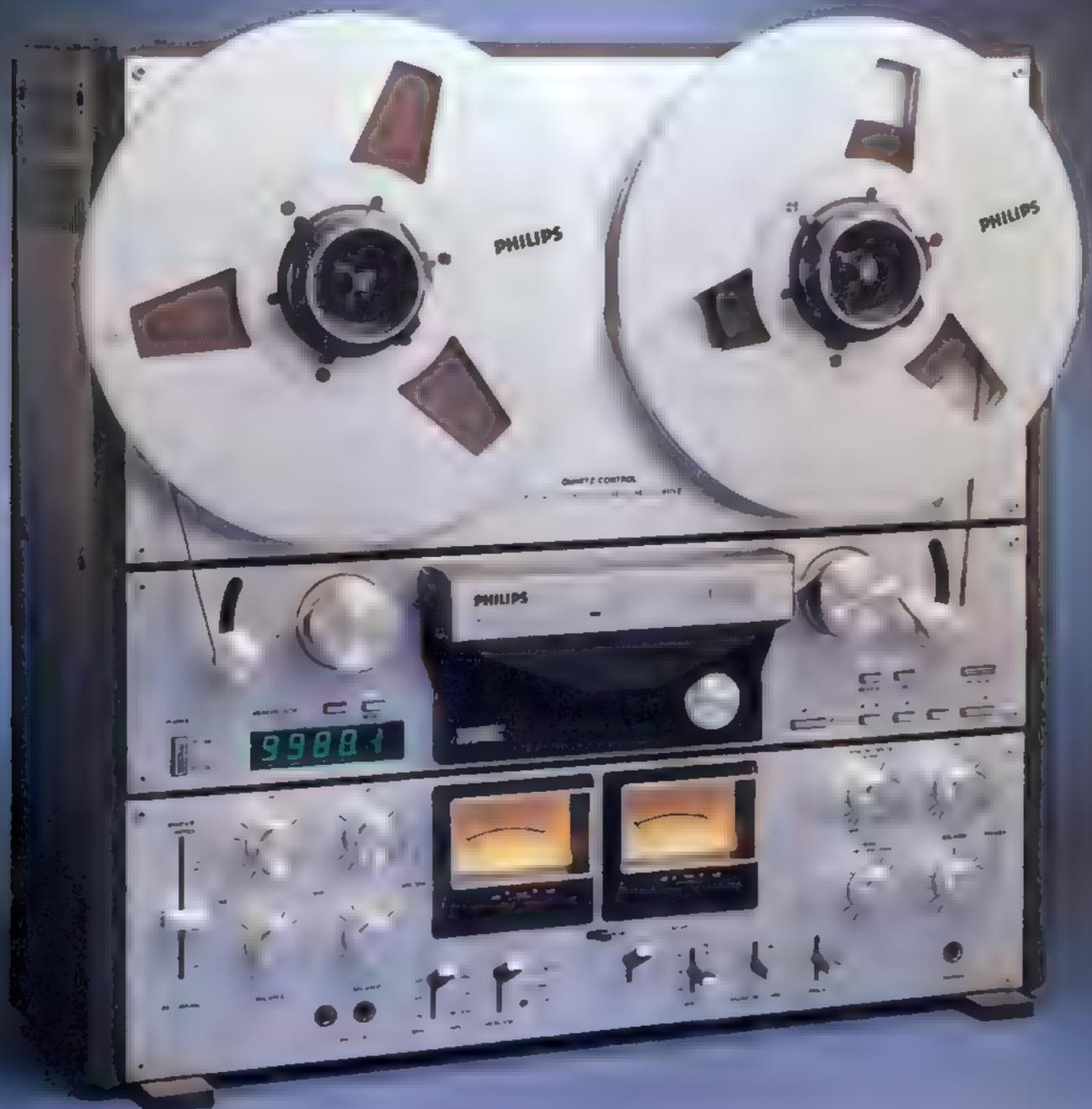
der Bandlaufaste; hierbei kann wahlweise mitgehört werden. Die Umspulggeschwindigkeit läßt sich in großen Bereichen stufenlos regeln (WIND SPEED). Außergewöhnlich ist auch die Vormagnetisierung. Wie bei professionellen Studiomaschinen kann die Vormagnetisierung mit dem Bias-Regler stufenlos auf die benutzte Bandsorte optimiert werden. In der rastenden Mittelstellung ist das Gerät auf das DIN-Bezugsband eingemessen.
