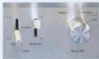
Der **Dubbing-Schalter** für separates Überspielen von Band a zu Band b oder umgekehrt. Daneben der Monitor-Schalter zum Abhören der beiden Tonbänder und rechts der Eingangsschalter für den Tuner, für zwei Plattenspieler und den Reserve-Eingang.
