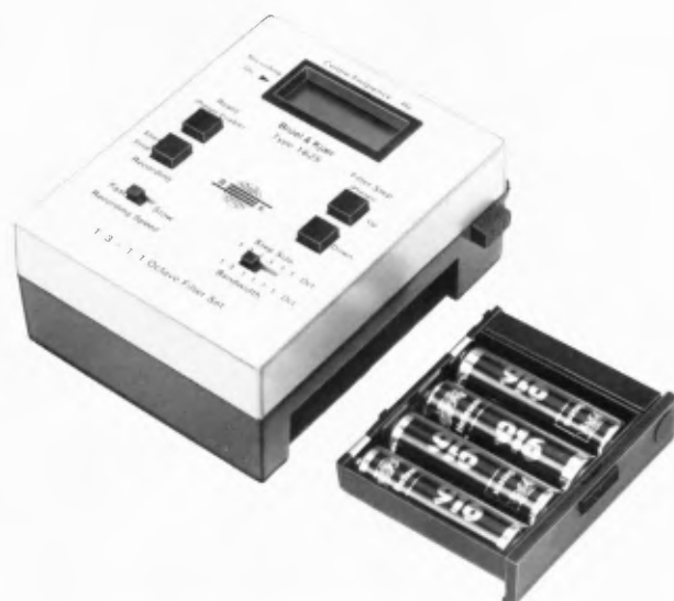
Fig. 3.3. Remplacement des piles
