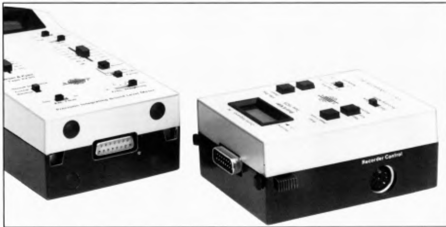
Fig. 3.2. Fixation du Jeu de Filtres aux Sonomètres Types 2230/33
